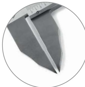
Напайный твердый сплав увеличивает срок службы данного инструмента в несколько раз по сравнению со штангенциркулями с обычными закаленными губками.
